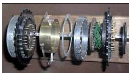
Bild 12: Innenleben einer Schlüsselwalze
