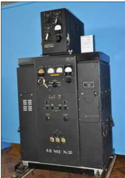
Le fleuron de l'exposition de HB4FR: la radio SE-402. Elle a été achetée par l'armée dans les années d'après-guerre, à ondes courtes SCR-499/A américaines. Ces stations étaient basées sur l'émetteur Hallicrafters HT-4, développé pour les radioamateurs, et sa boîte d'accord AT-3, les deux combinés avec des récepteurs Signal Corps BC-342 et BC-312. Dans l'armée Suisse, elle était d'abord désignée comme SM-46 et a été renommée par la suite en SE-402.
