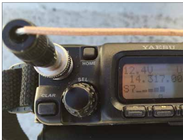
Bild 5: Koax geht mittels Cinch-Stecker auf den FT-817
