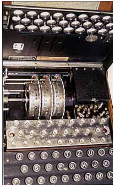
Bild 16: Innenleben einer deutschen 3-Walzen ENIGMA
