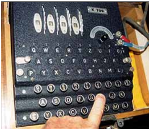
Bild 15: Tastatur und Lämpchenfeld einer Schweizer ENIGMA
