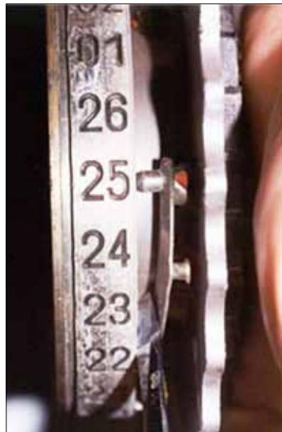
Bild 11: Schlüsselwalze - Einstellung des inneren Schlüssels
