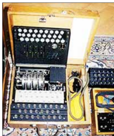
Bild 9 (dito Bild 8): Deckel abgehoben mit Sicht auf Lampen und Walzen
