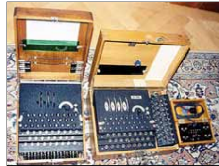
Bild 6: Zwei ENIGMA's - deutsche Wehrmachtsausführung (l.); Schweizer Ausführung, Typ K (r.)
