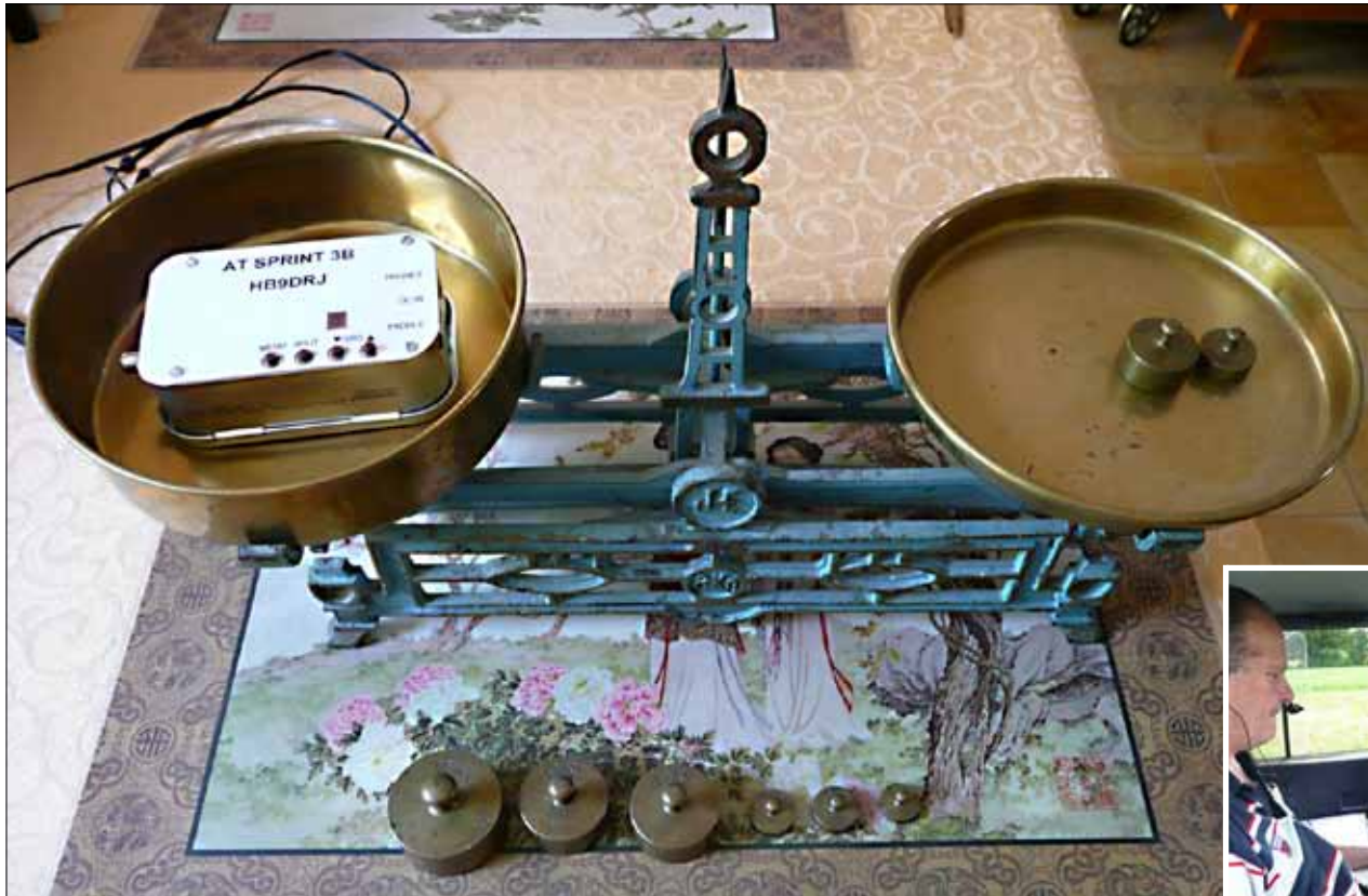
NMD 2010 - Der bekannte Mini-TRX AT Sprint 3B von Hans HB9DRJ wiegt genau 70 Gramm
