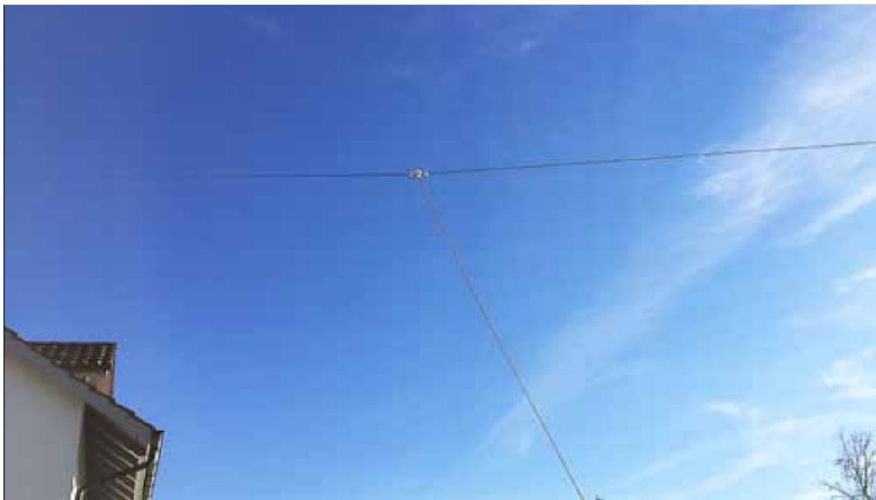
Bild 1: 85 Gramm-Superleicht-Dipol im Garten bei HB9ZCW
