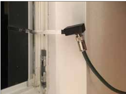
Koax-Fensterdurchführung (max. 100 W)
