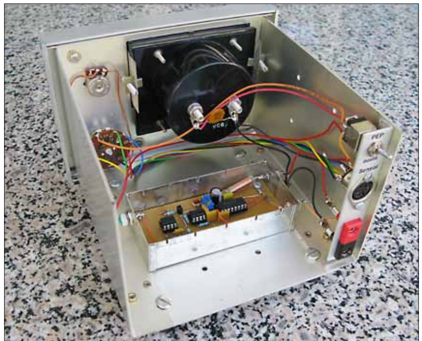
Ansicht des WH7 mit eingebautem PEP-Zusatz
