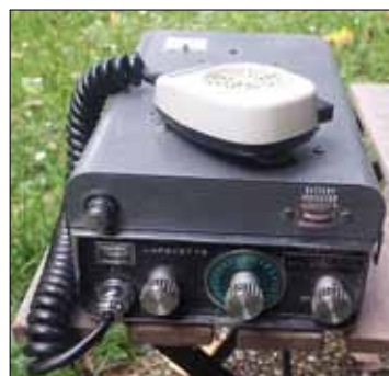
Das Lafayette mit 23 Kanälen und 500mW. Eines der ersten CB-Geräte mit PTT-Zulassung (1972).
