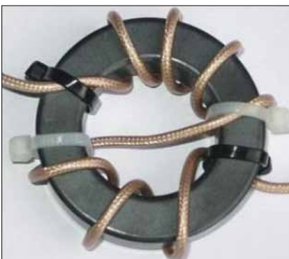
Balun für Steuerleitung des ATU
