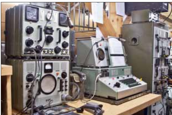
Senderempfänger SE-222, KFF 58 mit TC; SE-415 (Zellweger)
