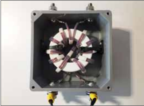
1:1 Balun zwischen Hühnerleiter und ATU
