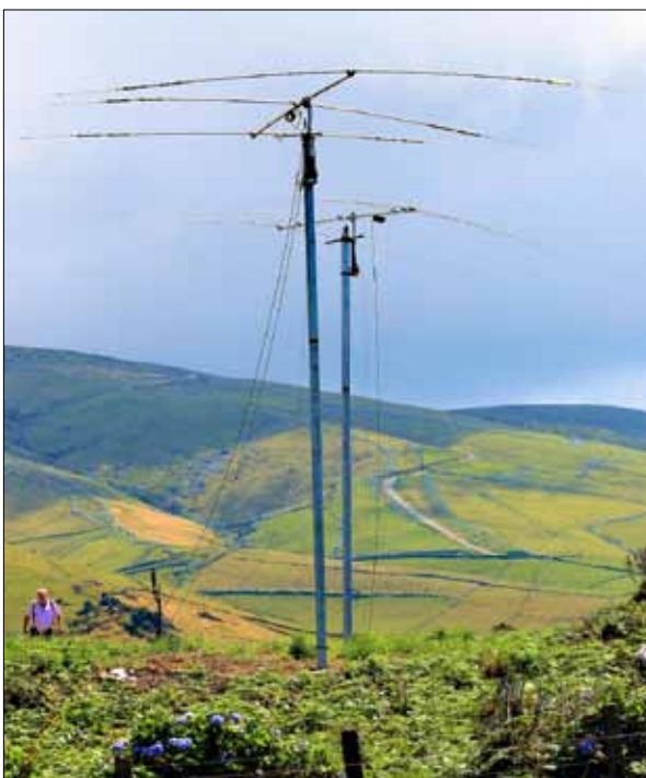
CR2V: Die beiden Beams Force12 und CushCraft A3S
