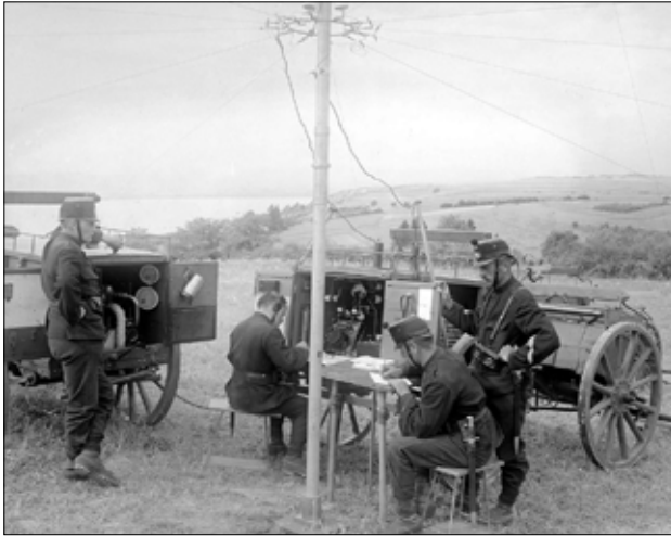
Übung mit einer auf Löschfunken umgebauten Schulstation (um 1914)
