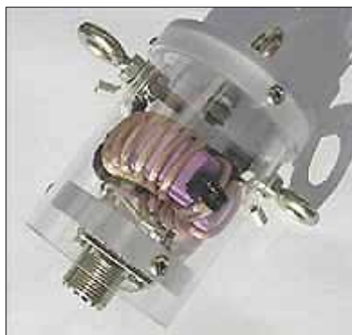
Fig. 1 - Prise coax avec balun
