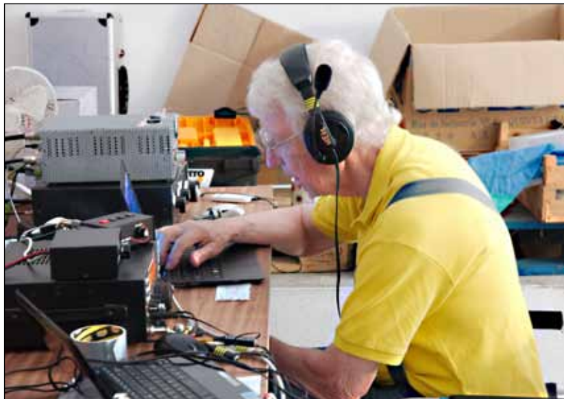
Hermann an der Multiplier-Station: K3 mit FET PA 500W
