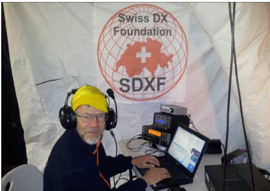
Hans-Peter HB9BXE, an der 40m Station; links der K3S mit Panadapter oben drauf. Auf dem Panadapter die Remotebox für die 40m 4-Square, rechts die KPA 500 Endstufe. Mitte: Laptop mit N1MM Log.
