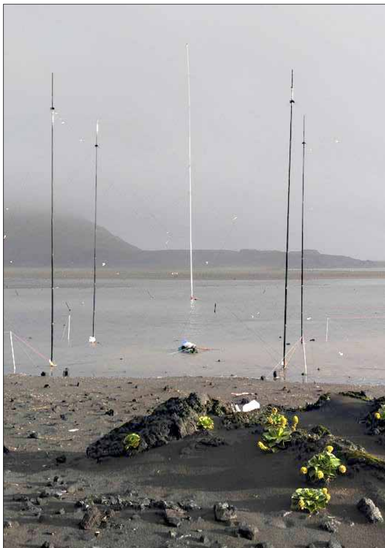
30m 4-Square (by HB9BXE) stand im Wasser. Ab Tag 4 wurde diese Fläche bis zum Schluss überflutet; im Hintergrund die 160m Vertikal.
