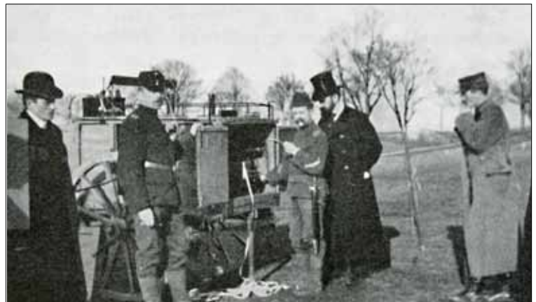
Thun 1905: Begutachtung mit Ingenieuren von TELEFUNKEN und Zuständigen aus der EMD-Beschaffungsstelle. Die Funktion des Morseschreibers (Papierstreifen) ist gut zu erkennen.
