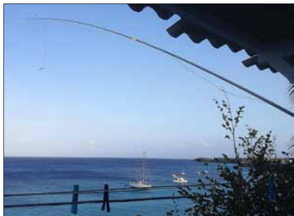
Der Linked-Dipol als Angelruten-Antenne auf dem Balkon
