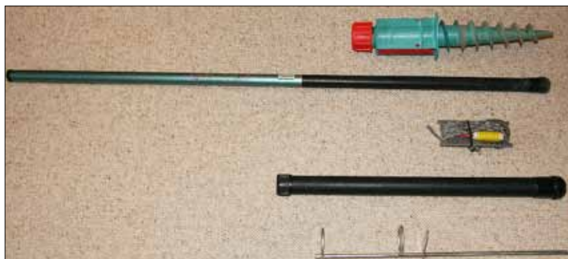
Foto 1: Masten mit Bodenhalterungen und die 20m Antenne aufgewickelt
