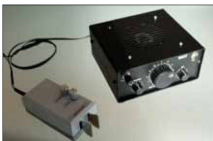
Photo 1: La réalisation de la construction d'un TRX TenTec 1340 en kit (7 MHz 3-4 Watts CW) avec le manipulateur CW Touch keyer
