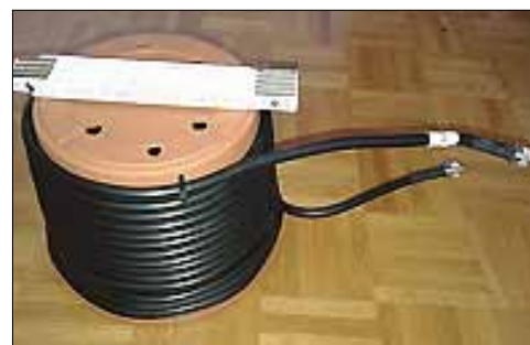
Fig. 4: Choque - 10m de coaxial bobiné sur un „pot d fleur“ d'environ 20cm de diamètre
