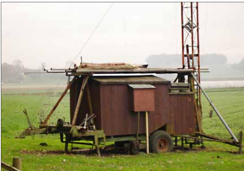
Masten (Farnisbaute) einer 160 Meter Deltaloop in der Landwirtschaftszone
