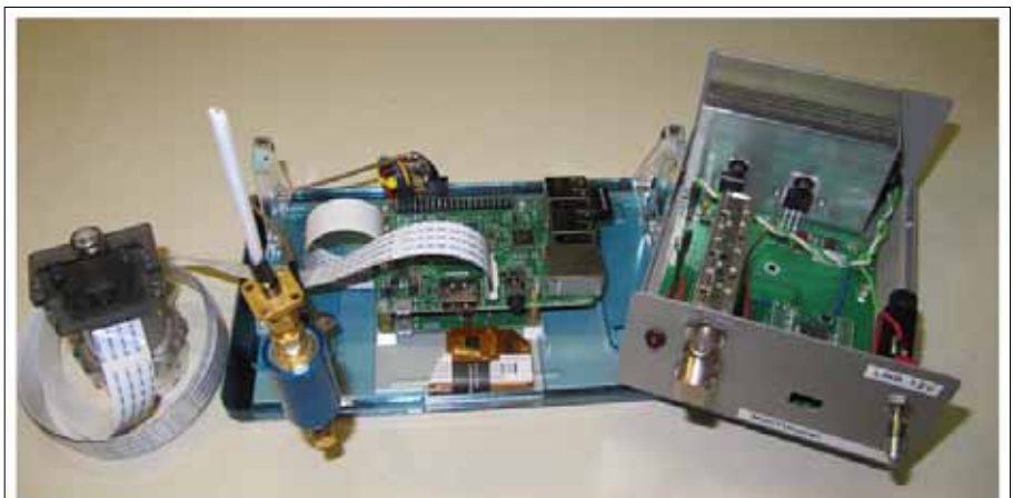
Figure 8: Raspberry Pi en émission et MiniTiouner en réception DVB-S sur 23 cm (Source: HB9DUG)
