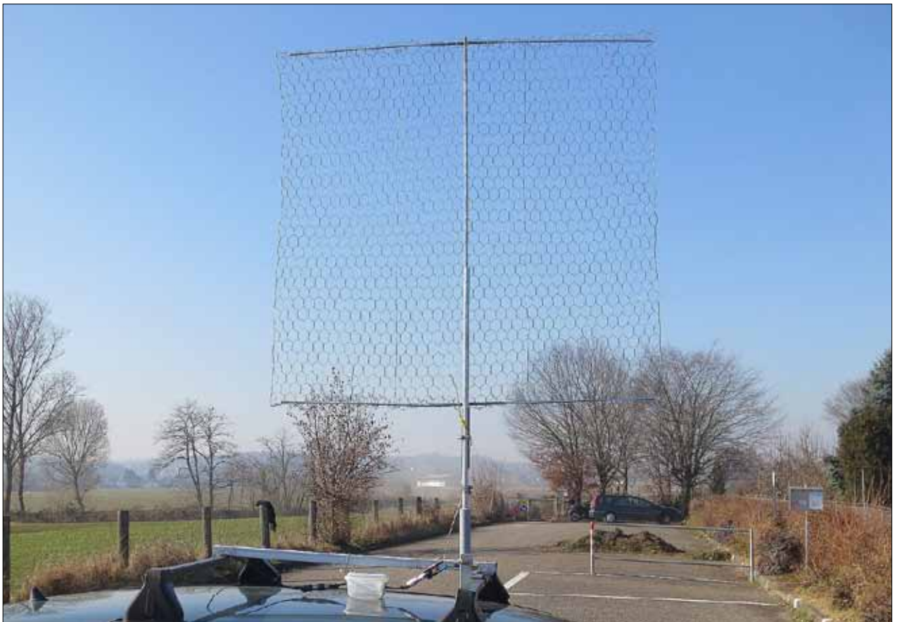
RoomCap-Antenne auf Auto-Dach montiert
