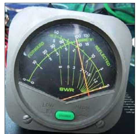
Bild 6: Das Varylink bringt's: SWR = 1,0
