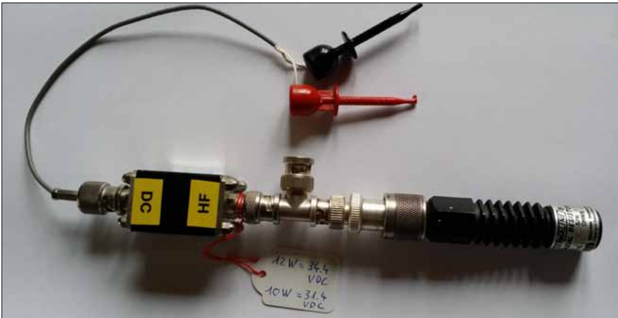
Messgleichrichter im BNC-Gehäuse mit T-Adapter zum Anschluss einer Dummy Load und der HF-Quelle
