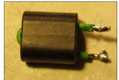
Sur les bandes ondes courtes amateur, on utilise en général le type «43»
