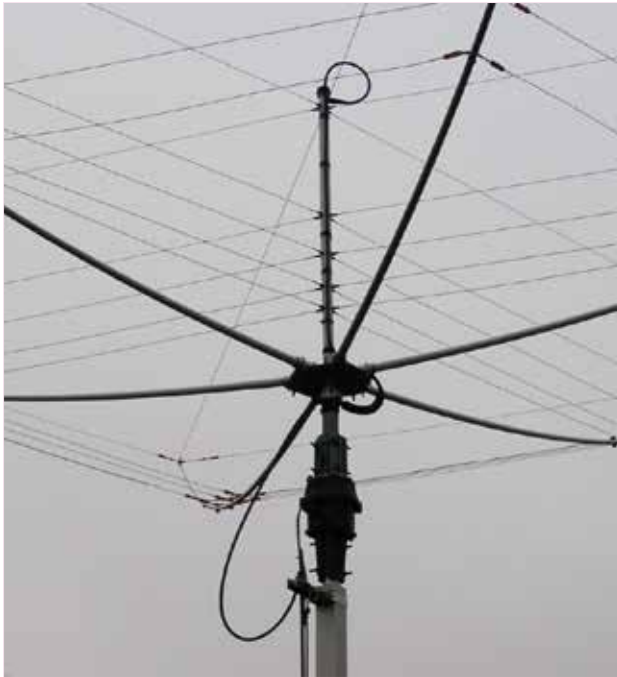
Fig. 3: alimentation et suppression courant de gaine / Einspeisung und Mantelwellensperre / RF-choke e cavo d'alimentazione
