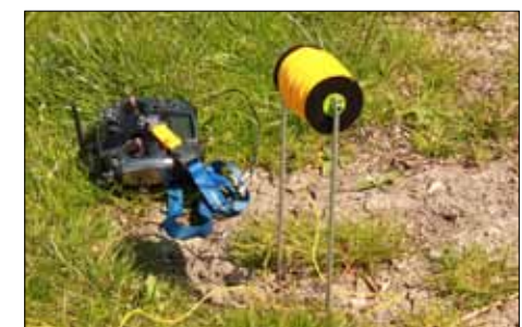
Abwickelvorrichtung für das Aufzugsseil
