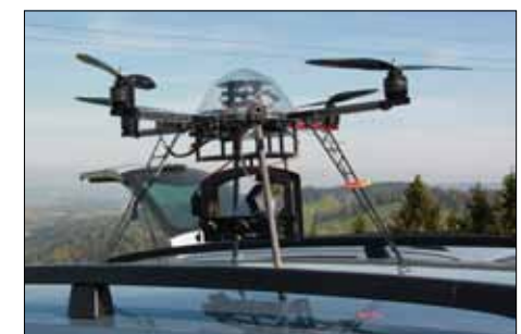
Quadrocopter auf dem PW-Dach
