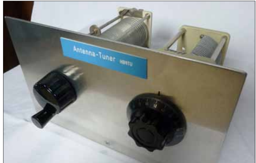
Tricky-Tuner auf einer beschichteten Spanplatte (Holz) montiert
