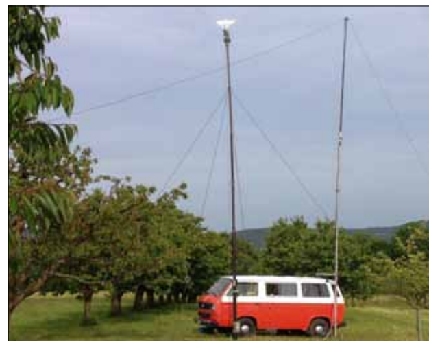
HB9EWY/p: Funkbus mit Delta-Loop und 2x27m Doublet in einem Kirschbaum-Hain ob Hornussen AG
