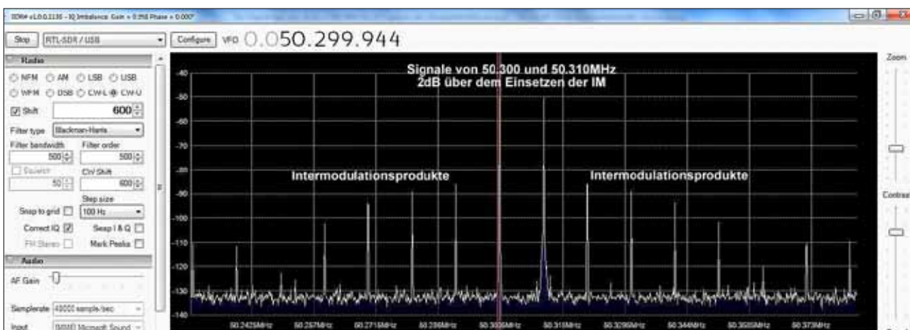
Fig. 8: Produits d'intermodulation de deux signaux à 50.300 et 50.310 MHz; chacun 2 dB après le début de l'IM
