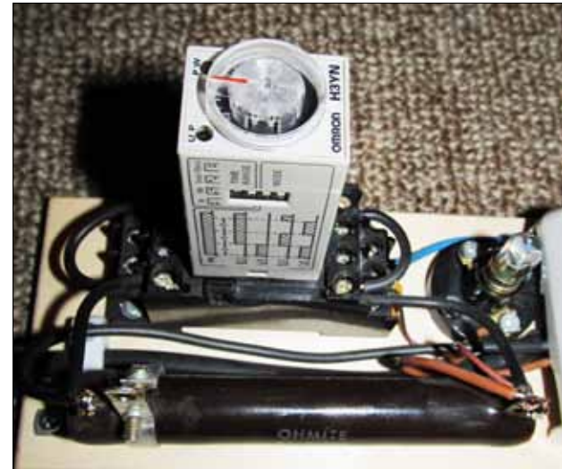
Das OMRON-Zeitrelais vertikal (weiss); der Widerstand horizontal im Vordergrund (schwarz) [Foto: HB9TU]
