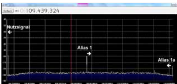
Fig. 6: Signal utili à gauche: signal alias au milieu et à droite
