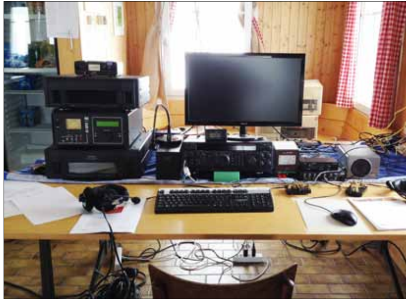
Der Shack von HB9KG mit FT-1000, 1kW PA VL-1000, ATU Palstar, PC, Rotorsteuerung und CAT
