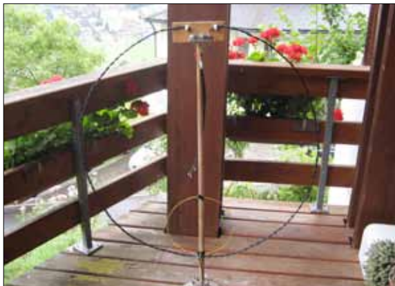
La loop se compose de 3 fils tressés [Fotos: HB9CAB]
