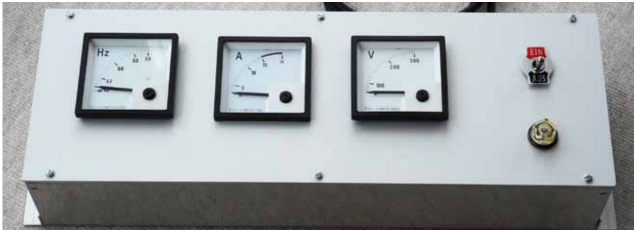
Netzbox zur Überwachung von Frequenz, Spannung und Strom im Felde
