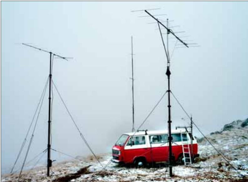
HB9EWY: 10 und 9 el. Yagi sowie eine 4 x 2 Quad Antenne auf dem Chasseron
