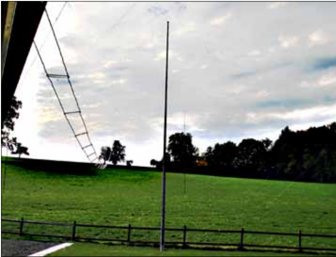
Horizontale Loop 4 x 21 m Seitenlänge mit Hühnerleiter
