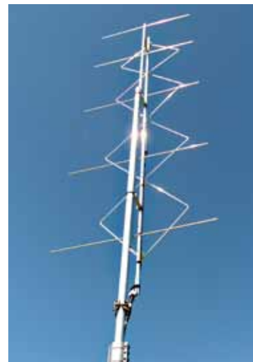
4-fach Quad mit einem Öffnungswinkel von 70°: von HB9LAW berechnet und von HB9AHD gebaut
