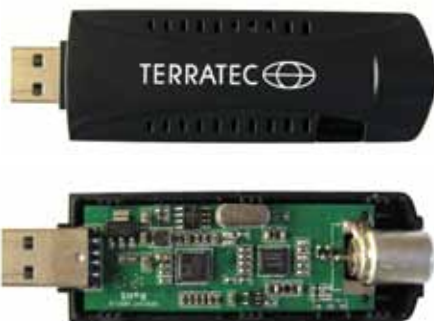
Fig. 1: und 2: DVB-T Dongle mit E4000 und RTL2832
