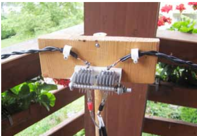
Einspeisung der Eigenbau-Loop
