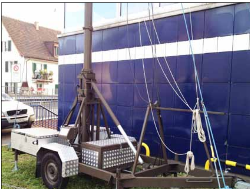
Antennenanhänger von HB9Z mit 16m Pneumatikmast
