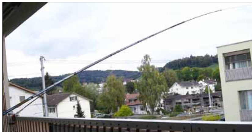
Sa whip hélicoïdale d'une longueur de 6 mètres
