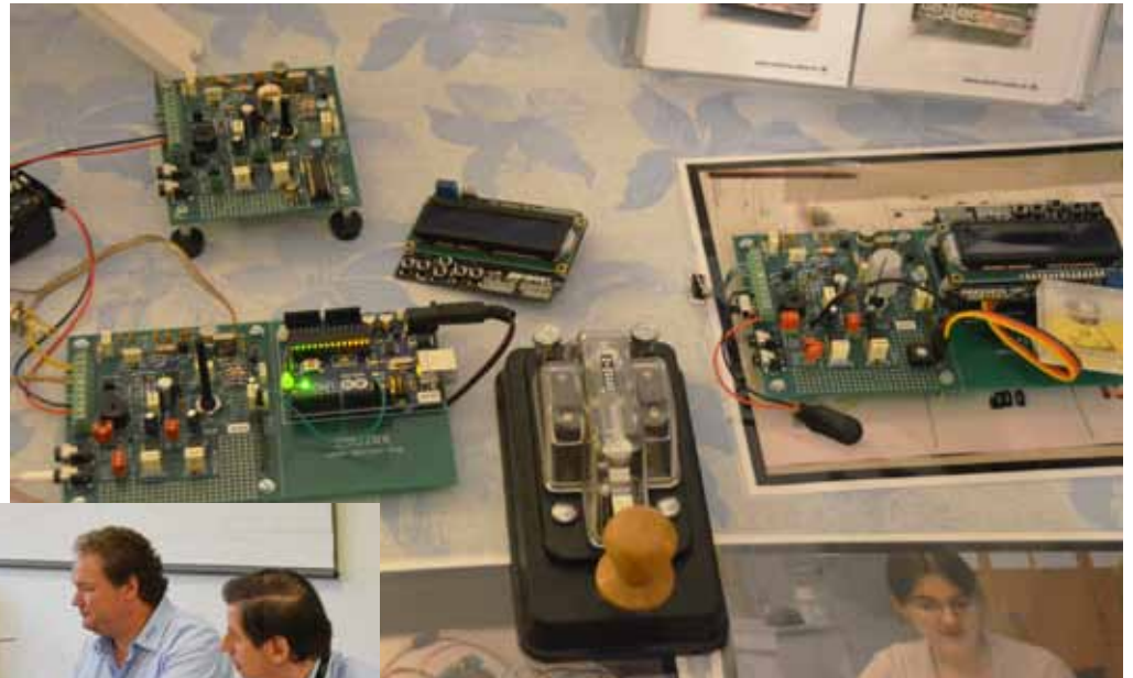
EDUTRX, der 250 mW QRP-TRX der Sektion Zug (vgl. Seite 18)
