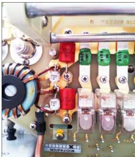
ATU-Erweiterung für 20 m mit 2x150pF (rot)
