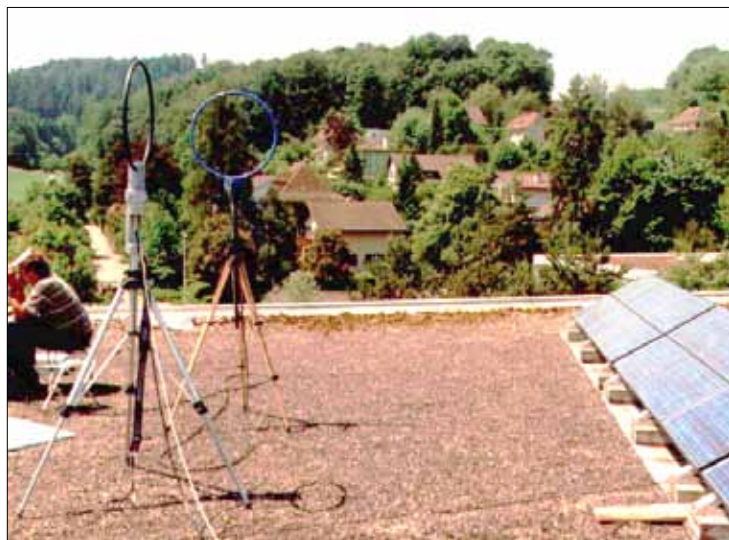
Foto 2: Mesurage de l'intensité du champ émis (distance 3m) d'une installation photovoltaïque 3 kW à Bertoud (27.05.1999)
