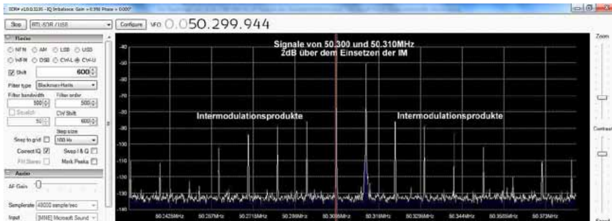
Figur 9: Intermodulationsprodukte mit Signalen von 50.300 und 50.310 MHz, je 2dB über dem Einsetzen der IM
