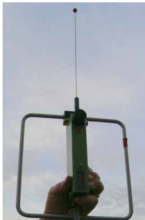
Rahmenpeiler mit Synthesizer (digitale Frequenzeinstellung)
