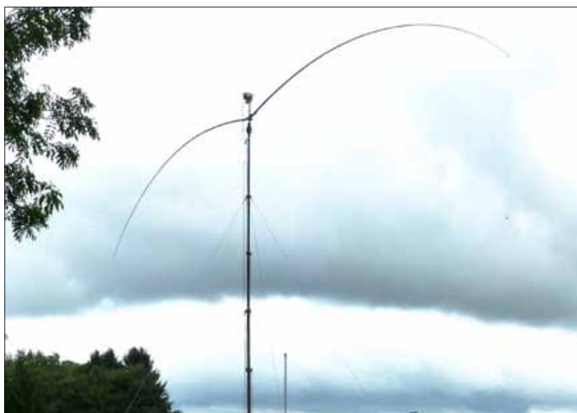
Bild/image 2: Dipolenden mit vertikal herunterhängendem Antennendraht an kleinen Gewichten (kaum sichtbar, vgl. Bild/image 1)
