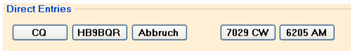
Bild 7: Die beiden Buttons ganz links lösen die Ausgabe selber aufgezeichneter Sprachsignale aus. Die beiden Buttons rechts stellen den TRX auf häufig benutzte Frequenzen ein.
