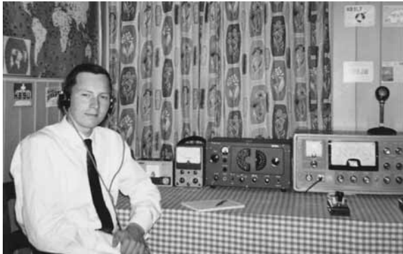
Photo 10: Station 1966 - jap. RX 9R-59, TX Gelsono G-222TR 50 Watt, SWR-Messgerät Heathkit
