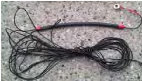
Fig. 12: L'alimentation Potter constituée par 10m de RG 174 et 20 perles ferrit CST 9,5/5.1/15-3S4 [9] emballées dans la gaine thermo-rétractable et renforcées dans les extrémités par un même matériel. Les perles seront dimensionnées de façon à coulisser librement sur le câble
