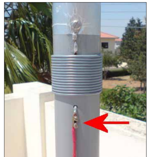
Bild 7: Der Pfeil markiert die Mitte des Dipols gemäss # 5 der Patentschrift
