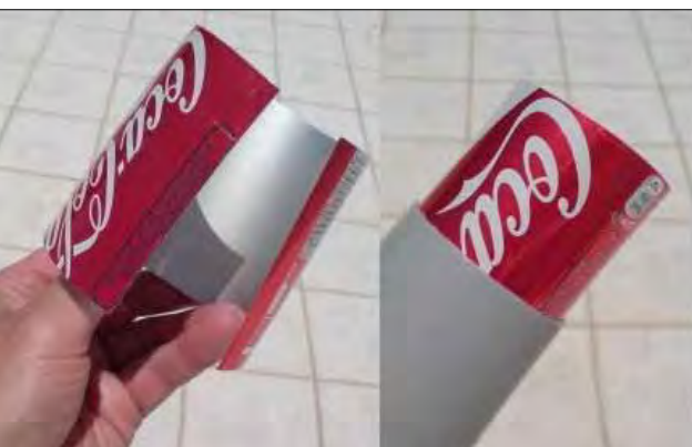
Bild 9: Eine aufgeschnittene Alu-Getränkedose dient dem Feinabgleich (z.B. bei Veränderung der Aufbauhöhe über Grund)
