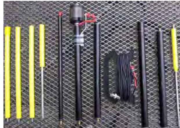
Fig. 15: Un compagnon fidèle lors de randonnées, mon Buddistick en configuration min. De droite à gauche: piquets de terre, 2 pièces bras d'antenne utilisé comme mât court, avec isolateur polyamide vissé, alimentation Potter, brin rayonnant constitué par 2x11" bras d'antenne, self et tube télescopique et à gauche le piquet de clôture pliable
