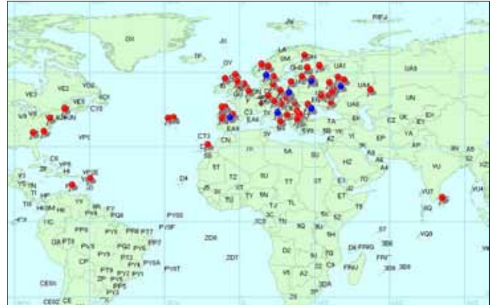
Bild 3: Resultate mit kapazitiven Antennen (Jan.-Feb. 2009): blau = 40m; rot = 30m - PSK31/63, FT-897D, 25-30 Watt
