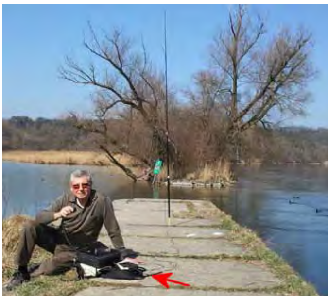
Fig. 11: HB9MTN a proximité du Rhin, le Buddistick installé près un môle. L'alimentation Potter posée à même le sol. La flèche indique les perles ferrit de la self d'arrêt. La participation au QSO des suisses de l'étranger avec 5 W était tout à fait réalisable.
