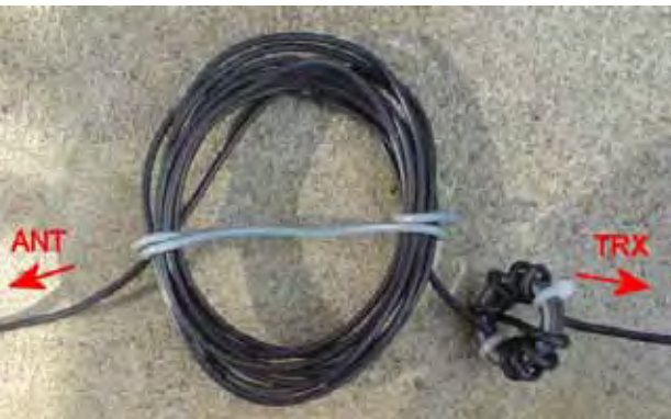
Bild 8: Zum Abgleich der kapazitiven Endbelastung und der QRG wird das Koax einfach über die Hand aufgewickelt
