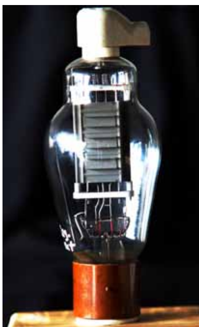
Bild 3: 811-A von RCA, mit primitiv verstärkter Anode
