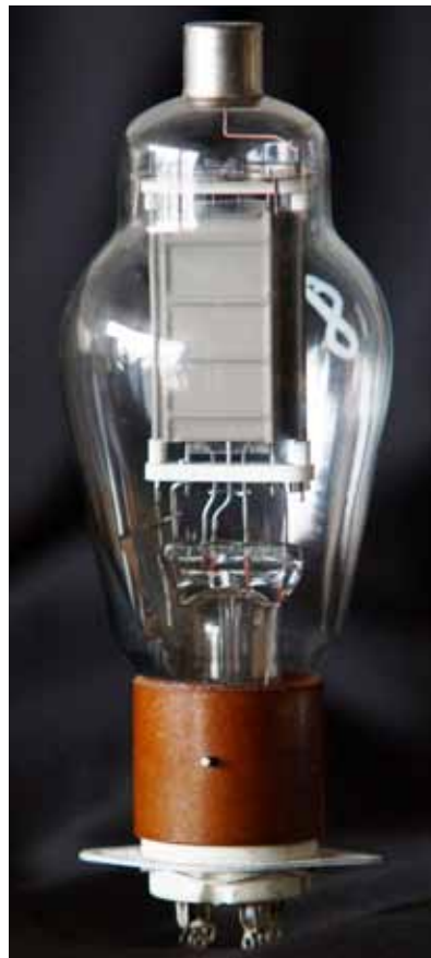
Bild 2: Alte 811 mit simpler Blechanode (1939)
