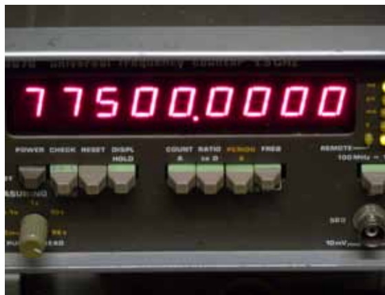
Bild 4: Zähleranzeige 77'500 Hz des Quarzoszils, Reziprozählung über 2. DCF-Zeitbasis
