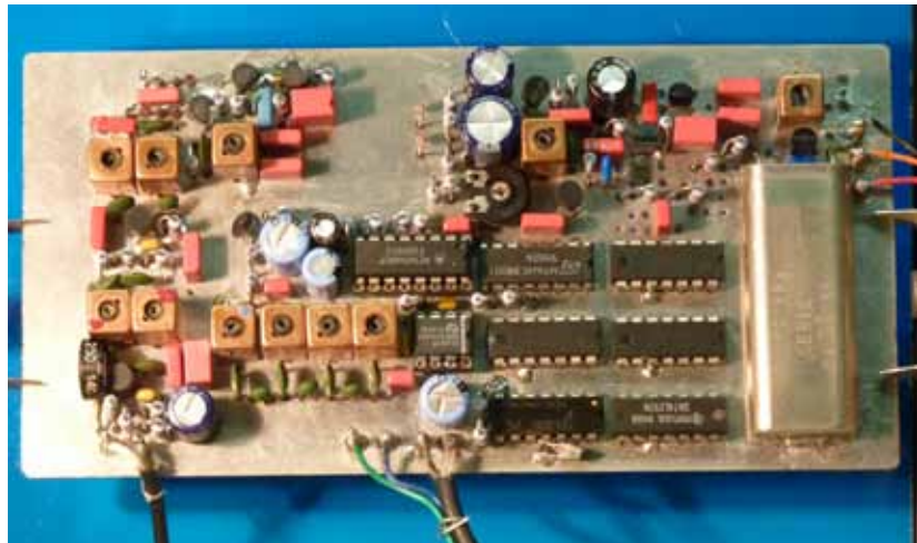
Bild 2: Zeitbasis mit Aufbaudetails (inkl. entbehrliches Hochpassfilter)
