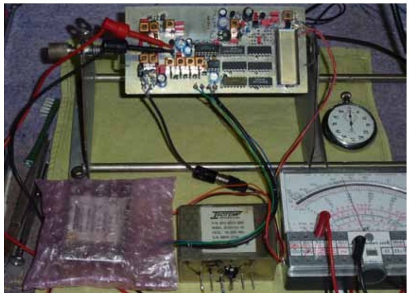
Bild 1: Zeitbasis-Print mit OCXO im Wärmebeutel, freilaufender Kontroll-OCXO; Messinstrumentanzeige = 4,0 Volt
