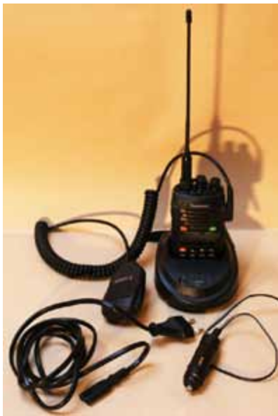
Bild/photo 3: Ladegerät - Chargeur avec câbles d'alimentation
