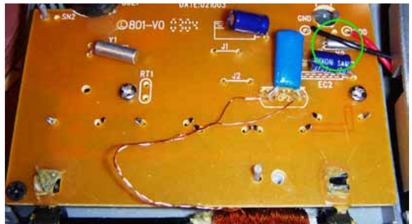
Image 2: Position du quartz radio à changer dans les réveils présenté dans la première partie de l'article
