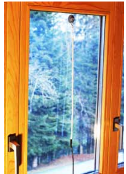
Bild/photo 4: J-Pole Antenne - fixée à la fenêtre par ventouse
