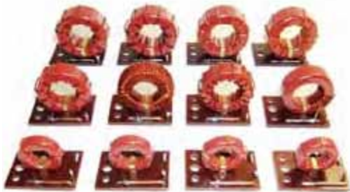
Bild 4. AMIDON-Ringkern-Größen. Von oben nach unten: T106-2, T94-2 und T68-2 Fig. 4. Tailles des noyaux toriques AMIDON de haut en bas: T106-2, T94-2 et T68-2
