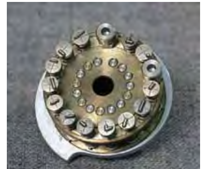
Bild 3. Der Kopf mit den 14 Stempeln, auf denen die Zeichenelemente sitzen. Der Durchmesser beträgt etwa 4 cm.
