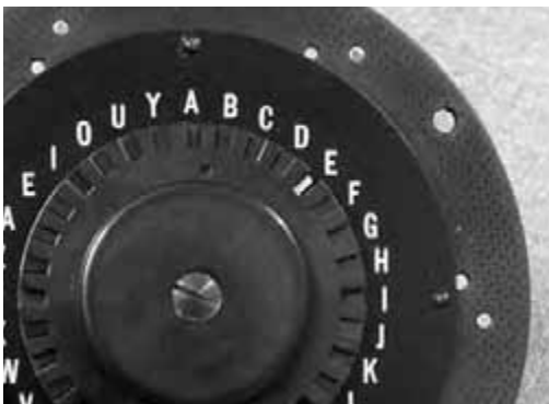
Bild 7. Das SPG. Fünf gezahnte Scheiben liegen übereinander. Bei jeder der 32 Kombinationen wird ein Buchstabe markiert, sechs sind doppelt vorhanden. Le SPG. Cinq roues crénelées sont superposées. Une lettre est marquée à chacune des 32 combinaisons, six sont disponibles.
