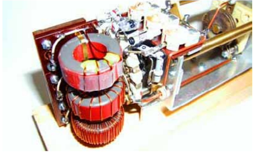
Bild 20. Neue HF-Vorstufe mit Ringkernspulen für meinen 1-v-2 Fig. 20. Nouvel étage préamplificateur HF pour mon 1-v-2 avec des bobines à noyau torique.
