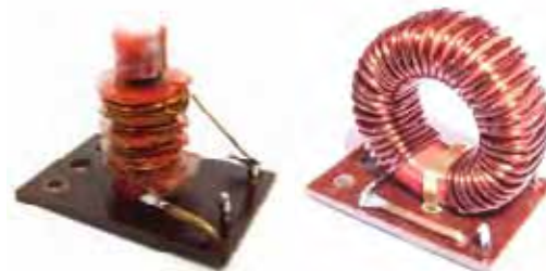
Bild 5. Spulenbausteine Links: Vier-Kammern-Spule mit verstellbarem Kern. Rechts: Ringkernspule Fig. 5. Les bobines
