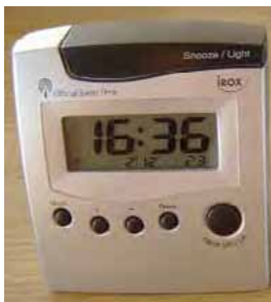
Illustration 2: Réveil radiocontrôlé sur HBG modifié pour DCF-77
