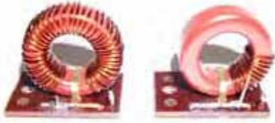
Bild 12. Versuchs-Ringkernspulen. Links: am Anfang. Rechts: am Ende Fig. 12. Bobinages à noyau torique d'essai – à gauche: au début, à droite: à la fin
