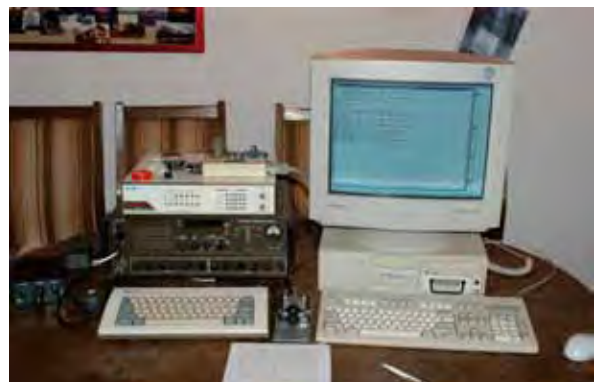
Photo 3: Années 1980 - RX/TX : Sunair, Décodeur: Tono et PC: Motorola PowerStack avec Windows NT 3.51
