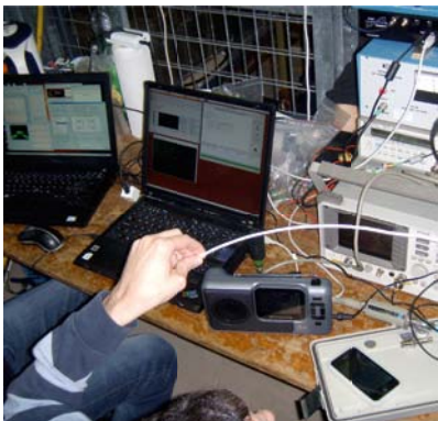
Installation pour essais de transmission en DRM
