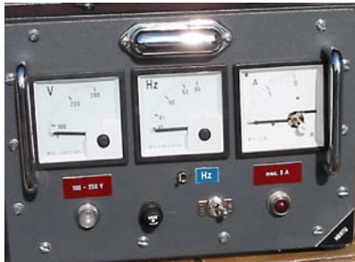
Bild 3: Messeinrichtung: Volt- und Ampèremeter inkl. Frequenzmesser. Eigenbau gemäss Schema 2
