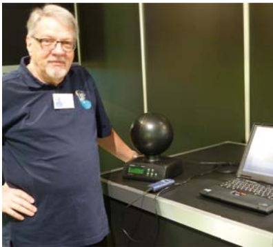
Claude HB9RSO demonstrier am SAR-Kopf (SAR=spezifische Absorptions-Rate) die Handy-Strahlung
