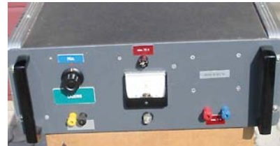
Bild 2: Akku-Ladegerät, 230 VAC, 12-15 VDC, 15 A; homemade; einfache und robuste Konstruktion, ohne Elektronik, mit Handregelung gemäss Voltmeter
