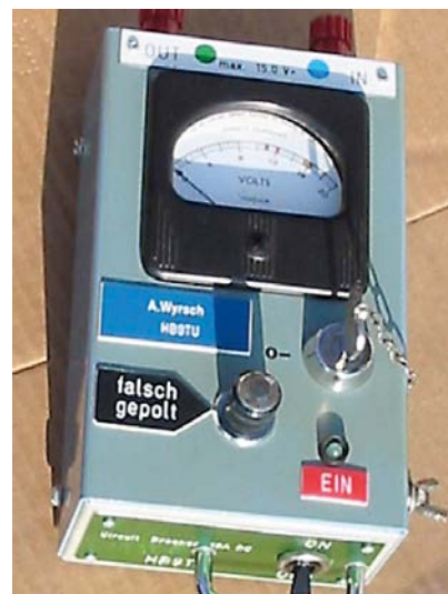
Bild 4: DC Voltmeter. div. Zusätze wie Schlüsselschalter, Kontroll-Lampe zur Anzeige «falsch gepolt» etc. sind je nach Bedarf möglich
