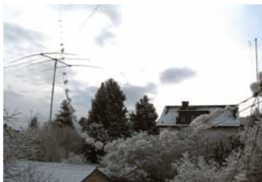
600 Ohm Speiseleitung für 2x15m Dipol im Winter bei Hans Bühler, HB9XJ.
