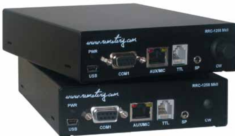
Bild 1: Remoterig. Zwei kleine Boxen sind das Herzstück des Fernsteuersystems.
