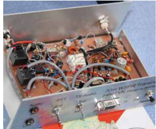
Der von HB9TVK nachgebaute WSPR-Transceiver von W3PM
