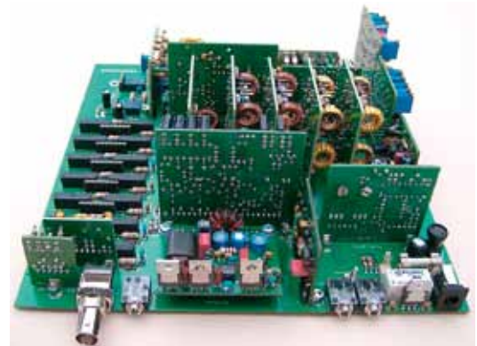
Mainboard des Solf-2009-QRP-Transceivers (nur eine der sieben Positionen für Lowpass-Filter bestückt).
