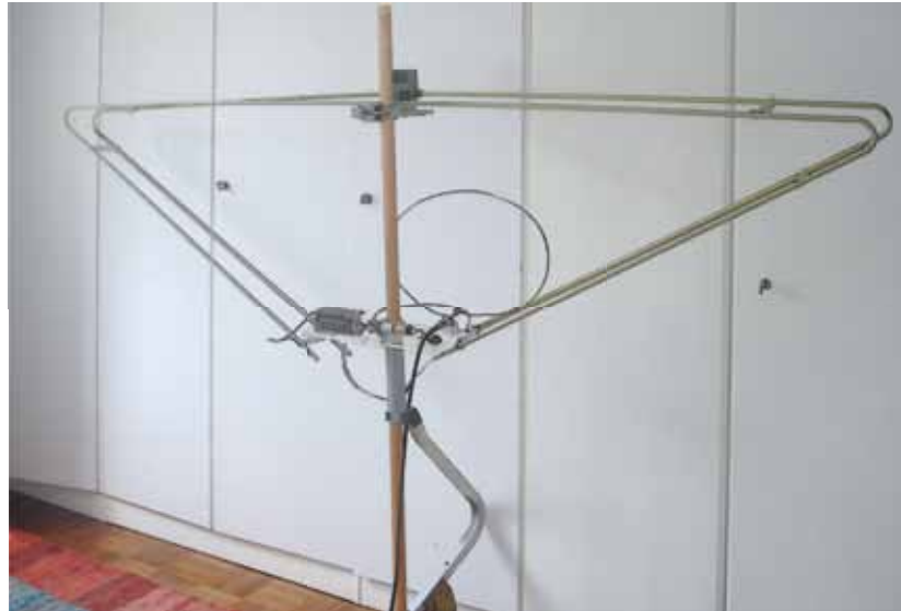
Photo 1: Vue générale de l'antenne magnétique compacte 80 m
