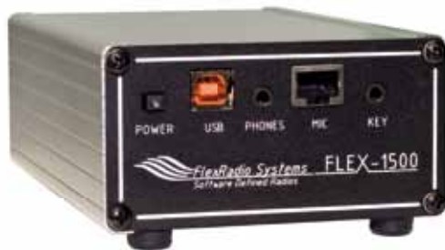
Viel Radio in einem kleinem Gehäuse: Flexradio 1500 mit 5 Watt Output.
