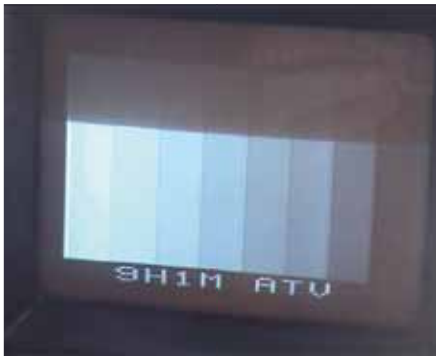
Das Signal von 9H1M in Korfu, empfangen am 1. August 2009 über eine Distanz von 650 Kilometern.
