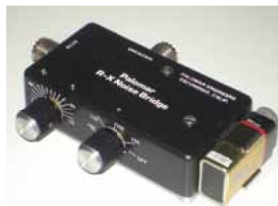
Photo 1: Pont d'impédance côté réglage.
