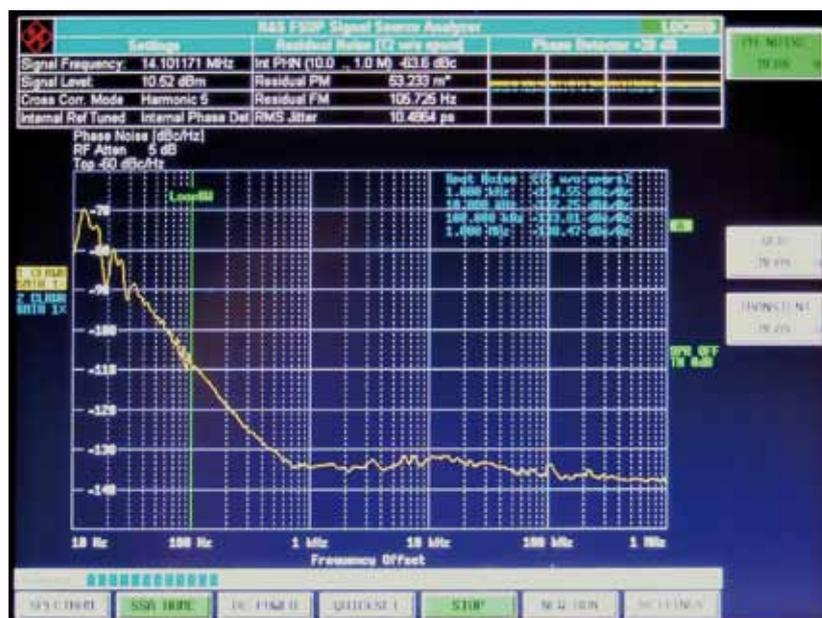
**Phasenrauschen des Sendesignals des ADT-200A, gemessen von Ulrich Rohde, N1UL (Bild N1UL)**
