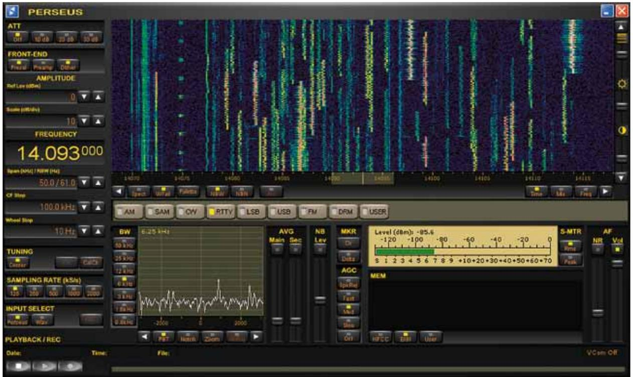
**Die Bedienoberfläche des Perseus mit dem Hauptdisplay (Wasserfall) oben und dem Filterdisplay links der Mitte unten. (Alle Screenshots HB9CET)**
