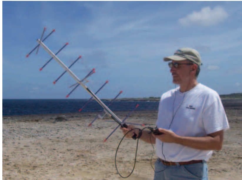
Bild 1: Beispiel einer portablen Satellitenstation mit Handfunkgerät und Dual-Band-Yagi. (@KÖNR)
