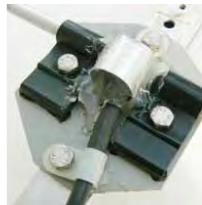
Bild 4: Detailaufnahme des Mittelteils des Dipols. Der Schwingkreis ist mit Heissiegel mittig in die Schlaufe eingeklebt.
