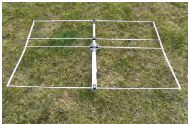
Bild 5: 4-Element-Beam HB9AIR. GFK-Verbinder zwischen den Elementen erhöhen die Stabilität. (Bilder HB9AIR)
