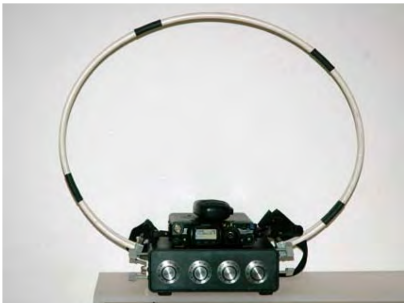
Damit peilt HB9LCA Störer: FT-817 und Magnetloop von DL4KCJ.
