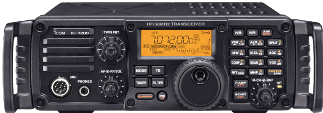
HF/6 Meter (RX 0.030 – 60.000 MHz), TX 100 Watt Betriebsarten USB, LSB, CW, RTTY (FSK), AM lieferbar ab Oktober 2008
