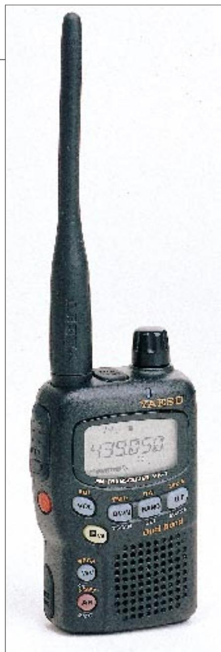
quenzunterdrückung im 2-m- und im 70-cm-Bereich deutlich besser aus, als in den anderen Bändern. Sie beläuft sich hier auf etwa 55 dB im 2-m-Band und liegt für 70 cm um 45 dB. Darin zeigt sich letztlich die primäre Zweckbestimmung des Geräts – der Amateurfunkbetrieb.
